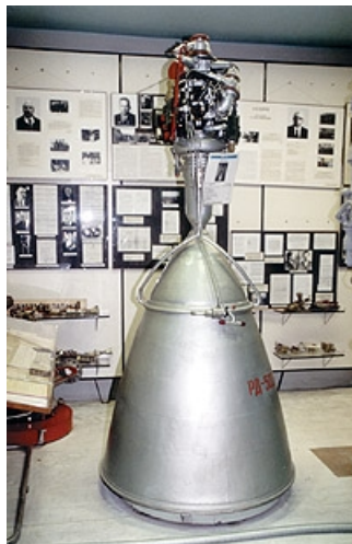
Экспериментальный двигатель РД-502 на компонентах «перекись водорода – пентаборан».
