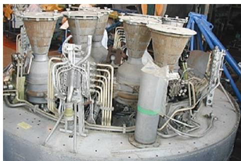
Единственный перекисной двигатель, который «увидел космос» – Gamma 8 для первой ступени РН Black Arrow.
